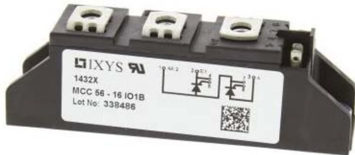
Encapsulado tipo "modulo" para dos tiristores Izquierda: vista del módulo Derecha: Dimensiones y esquema de conexión interna
