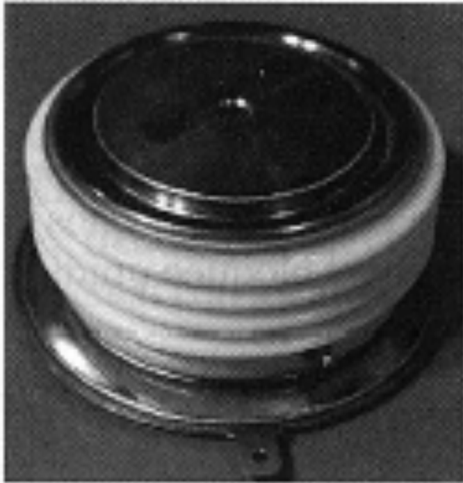
Tiristor en encapsulado tipo "hockey puk" (izquierda) y montado en su disipador de calor (derecha).
