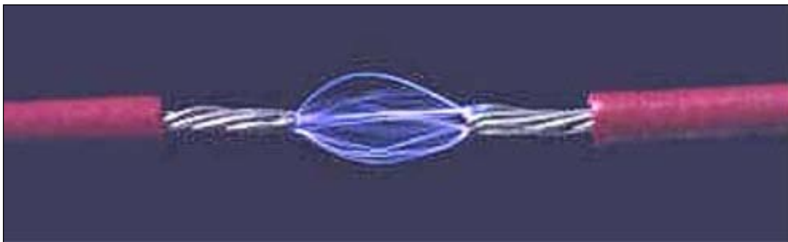
Arco eléctrico producido al cortar un conductor en presencia de corriente circulante.
