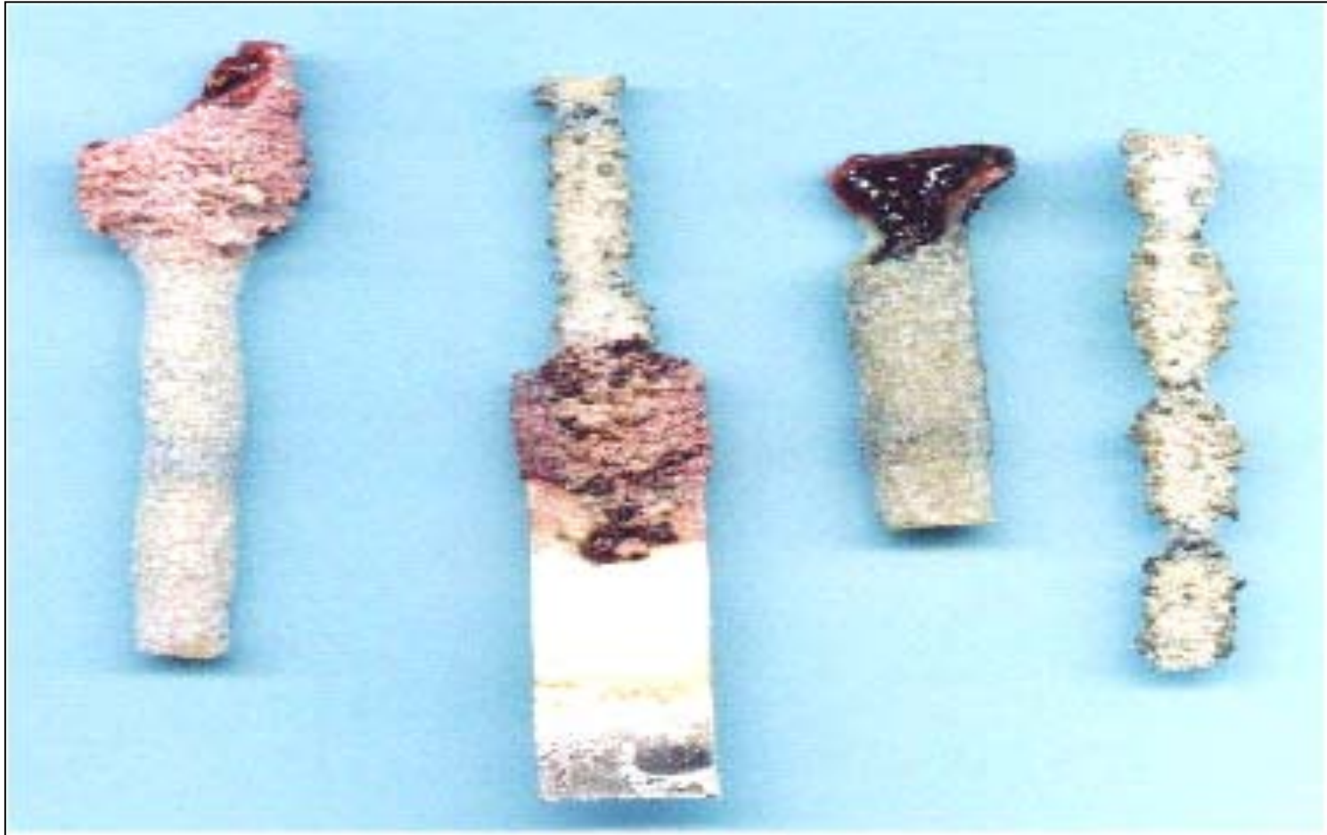
Partes no fundidas de elementos fusibles después de una falla, mostrando la escoria formada por la fusión de la arena con el metal conductor (plata).
