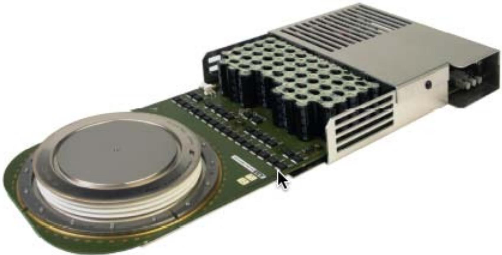
IGCT: RC-GTO a la izquierda, circuito de manejo de compuerta a la derecha. La flecha señala el conjunto de MOSFETs que manejan el pulso de corriente de apagado; inmediatamente a continuación está el arreglo de condensadores del circuito de apagado.
