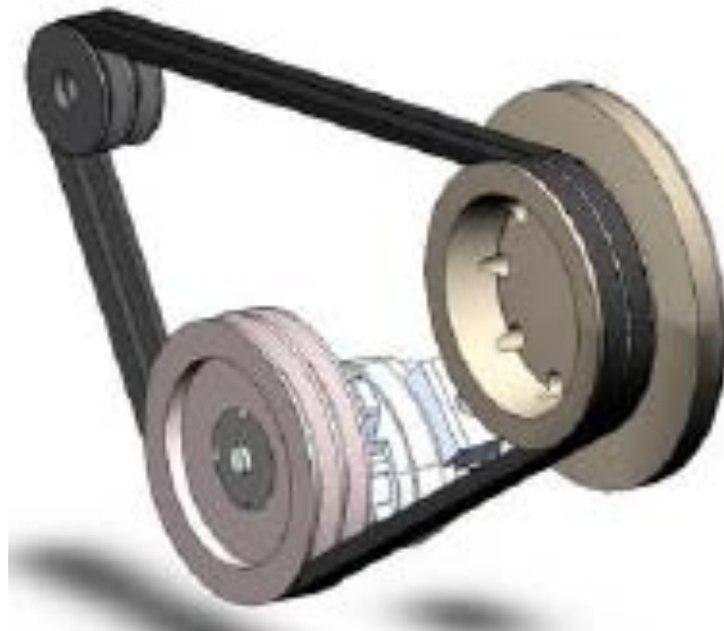
Sistema poleas-banda con dos cargas alimentadas con una sola banda
