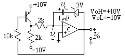
2.- Determine y grafique las formas de onda de  $v_x(t)$  y  $v_o(t)$  para  $t > 0$ , indicando todos los tiempos y amplitudes de interés.  $V_H=10V$ ,  $V_L=0V$ ,  $V_Z=3V$ . Asumir  $v_C(0^-)=0$ .
