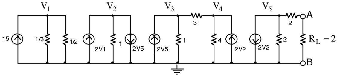
La parte del circuito que incluye los voltajes  $V_3$  y  $V_4$  no tiene efecto sobre la salida (es una parte aislada y ninguna fuente depende de variables contenidas en ella) y puede omitirse del análisis. El circuito para hallar  $I_N$  será:
