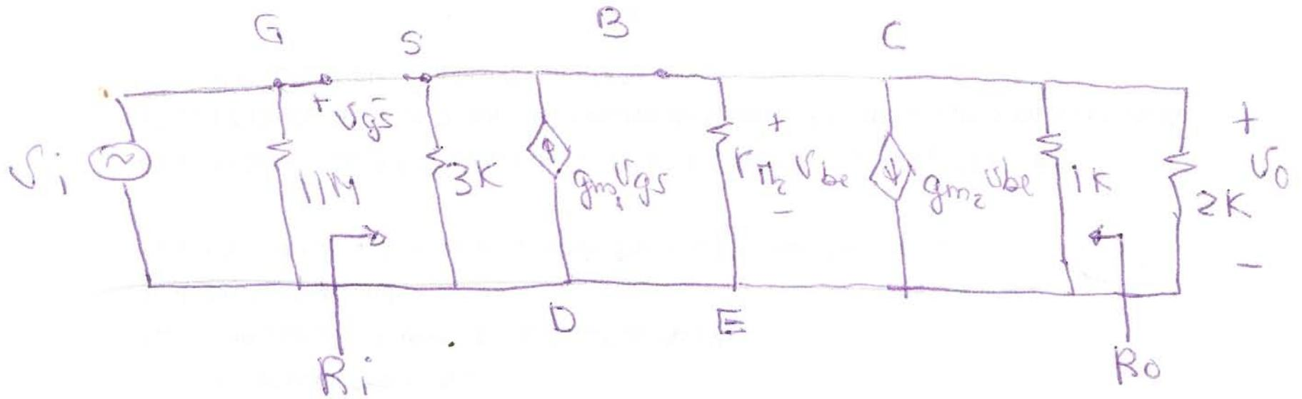
$$v_o = -g_{m2} (1K \parallel 2K) v_{be}$$
