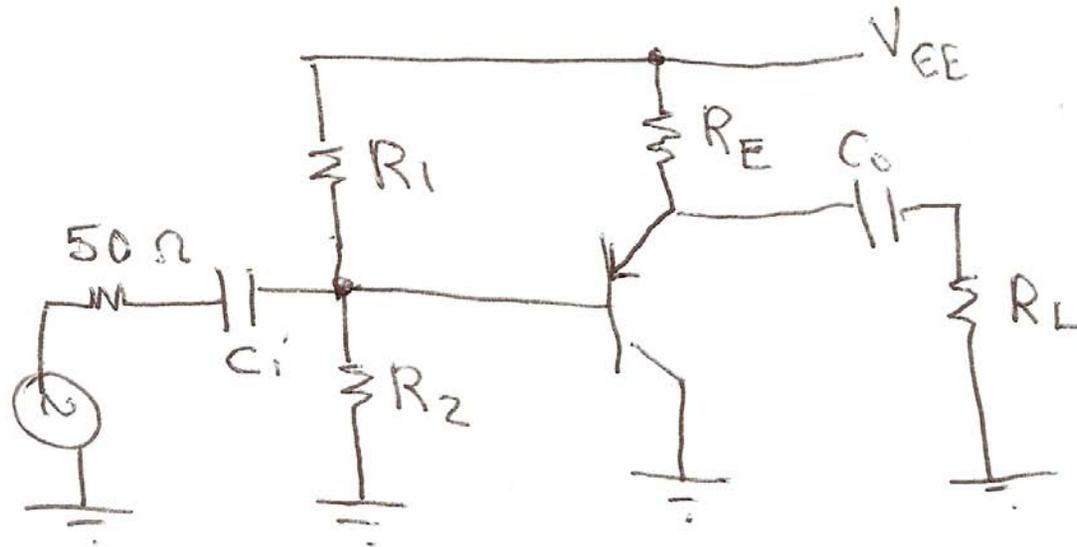
Diseñar un amplificador con la configuración dada, de forma que la ganancia sea igual o mayor que 0,9, la resistencia de entrada sea mayor que  $3\text{k}\Omega$  y presente una excursión del voltaje de salida de hasta 4 V con  $R_L = 1\text{K}\Omega$ . Considere  $V_{BE} = 0,7\text{V}$  y  $\beta = 100$ .
