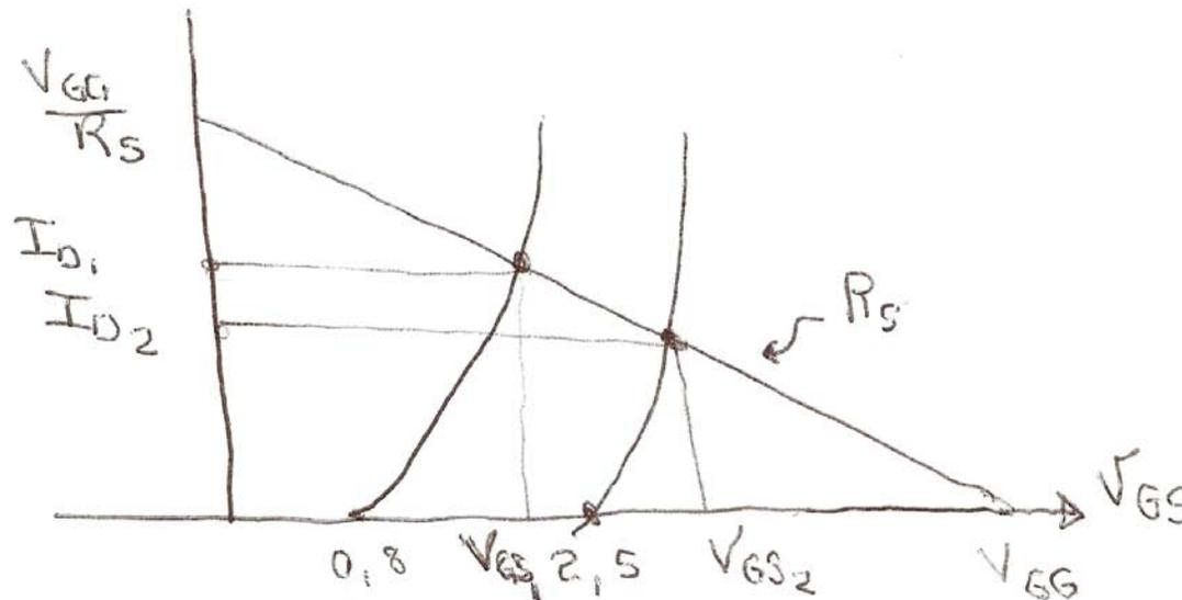
En la gráfica está el valor mínimo y el valor máximo de  $V_{GS}$  con sus correspondientes  $I_{D1}$  e  $I_{D2}$ .
