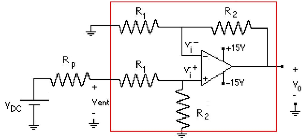
Se ajusta  $V_{DC}$  para que la salida sean 5V y  $R_p$  del orden de los  $k\Omega$
