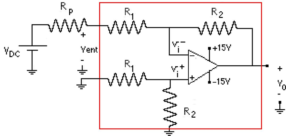
Se ajusta  $V_{DC}$  para que la salida sean 5V y  $R_p$  del orden de los  $k\Omega$
