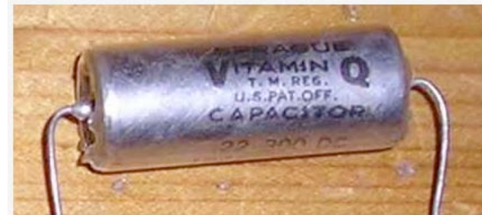
Capacitor con Papel Impregnado como Dielectrico
