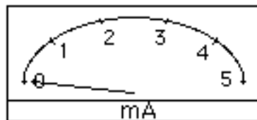
Fig. 4.- Escala de un miliamperímetro
